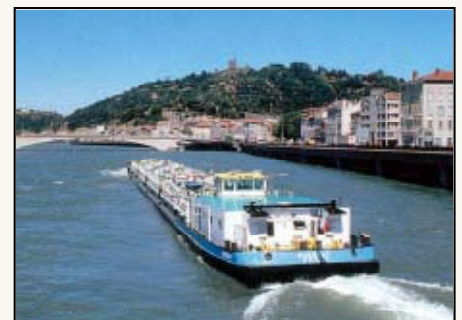
Transport de marchandises, de type « convoi poussé » : barges poussées par un automoteur (photo VNF)
